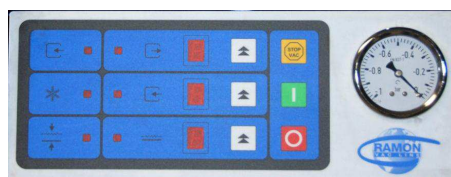
PANEL DE CONTROL VACIO Y GAS
